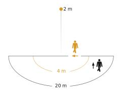
Possibile altezza di montaggio: 1,80 m - 2,50 m
